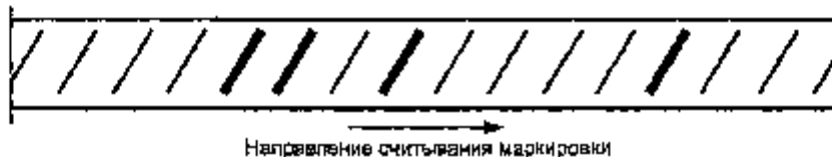
Рисунок 2 — Пример прокатной маркировки предприятия-изготовителя код номером 14
